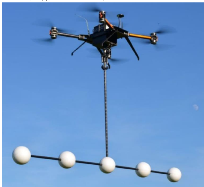
Рис. 1. Октокоптер с пятью феррозондовыми магнитометрами. Вертикальная полоса длиной 1,50 м. Горизонтальная стрела шириной 2 метра. Датчики равномерно разнесены на 50 см.
