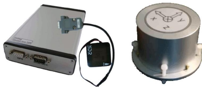
Рисунок 3: Трехкомпонентный феррозондовый магнитометр и система сбора данных.
