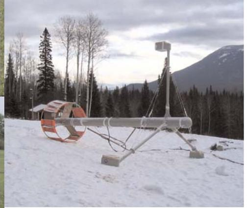
Магнитометр, вертикальный/горизонтальный и трехмерный градиентометры созданы на основе модели датчика GSMP-35A с высоким разрешением.
