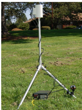
Магнитометрическая станция G-857 и навигатор Garmin GPS в заказной комплектации
