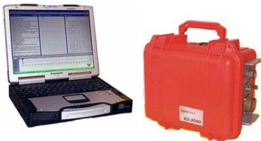
Вы можете управлять сейсмографом ES-3000 посредством своего портативного ПК с установленной программой сбора данных ESOS.
