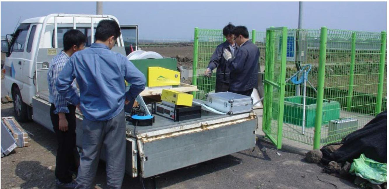
Каротаж с применением лебедки, установленной на грузовике
