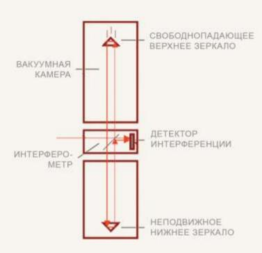
Траектория свободного падения падающего тела соотносится с высокоустойчивой системой активных пружин, которая имеет название «суперпружина». Суперпружина обеспечивает сейсмоизоляцию эталонного оптического устройства, что улучшает шумовые характеристики гравиметра А10.
