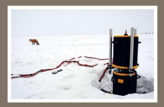
Система A10, развернутая с трактора Sno-Cat в Арктике (-40°C. Обращаем ваше внимание, что для таких экстремальных условий требуется внести небольшие изменения в стандартную конфигурацию прибора).
