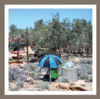
Система A10, развернутая с легкового автомобиля в Австралии (+40°С. Обращаем ваше внимание, что для таких экстремальных условий требуется внести небольшие изменения в стандартную конфигурацию прибора).
