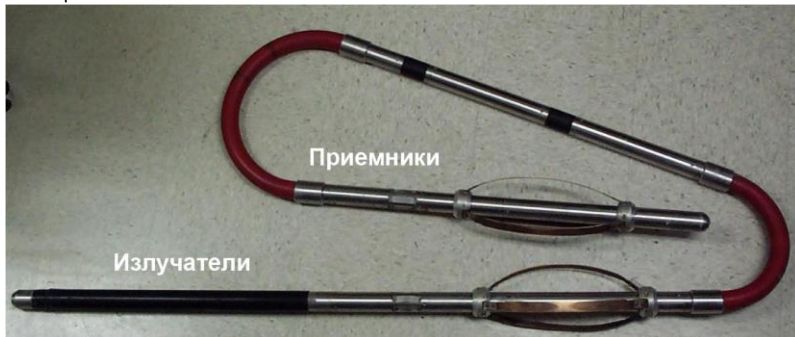
Скважинный зонд 2SAA(F) FWS с 2 излучателями, 2 приемниками, с 2-м изолятором
