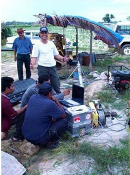
Проведение каротажа с помощью лебедки Mini
