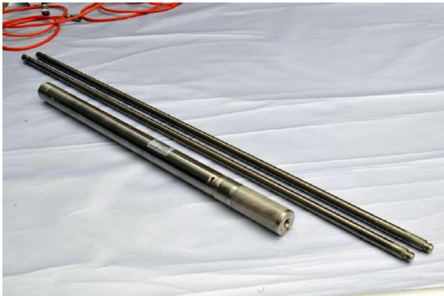
*Толкатель зонда для горизонтальных или наклонных скважин*
