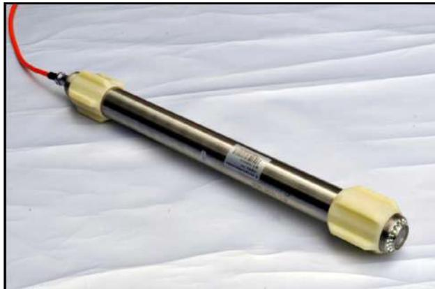
Зонд Ф40 для горизонтальных/наклонных скважин
