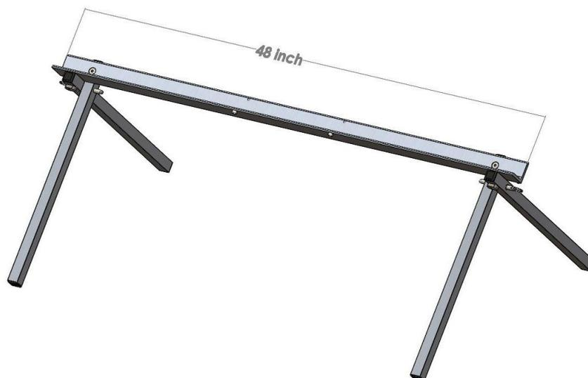
**Компания Mount Sopris разработала новую зондовую стойку, которая позволяет быстро подключать геофизические каротажные инструменты в полевых условиях.**
