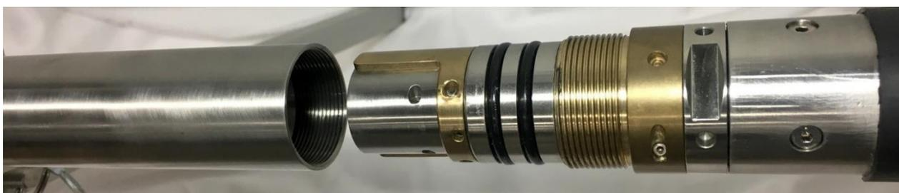
**Базовый имитатор лебедки, одножильный кабельный наконечник к 18-контактному разъему консоли Matrix/Scout**
