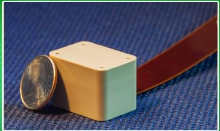
Сенсорный блок с использованием технологии MFAM.
