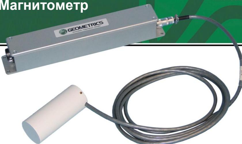
G-824A сочетает в себе проверенный высокопроизводительный цезиевый датчик с новым чувствительным внутренним устройством и электроникой счетчика Ламоровой частоты. Улучшенные малошумящие усилители теперь снизили минимальный уровень шума примерно до 350 fT (фемтотесла =  $10^{-15}$  Тл). Этот усовершенствованный встроенный магнитометр обеспечивает непревзойденную универсальность в работе, небольшой размер, малый вес, широкий диапазон применения и экономическую эффективность.
