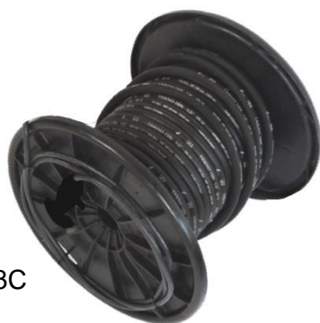
Гирлянда многоприемникового скважинного геофона намотана на барабан
