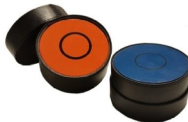
Низкий и высокий диапазон (левый и правый) Плоские Калибровочные Модели Магнитной Восприимчивости
