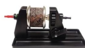
Модель ВП/Сопротивления с держателем образца КТ-20 IP
