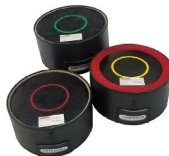
Низкий (красный), средний (желтый) и высокий (зеленый) диапазоны Плоские Эталонные Модели Проводимости
