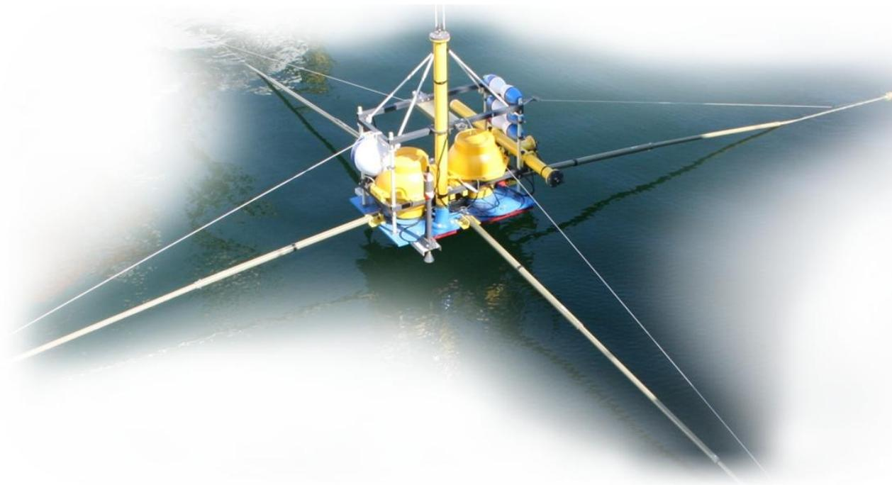
Системы 5AUSS-07A производства канадской фирмы «Advanced Geophysical Operations and Services Inc» предназначены для проведения морских электроразведочных работ на глубинах до 200 метров. Системы базируются на использовании высокоточного и высокочувствительного наземного геофизического оборудования для электроразведочных поисковых работ и построены таким образом, что оборудование с легкостью можно использовать как в сухопутном варианте, так и для синхронной наземной и морской съемки.
