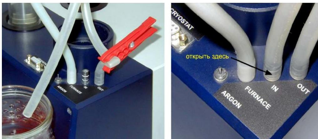
Будьте осторожны при выполнении этой операции, накройте измерительные катушки, чтобы обеспечить их сохранность. Для того, чтобы на время
