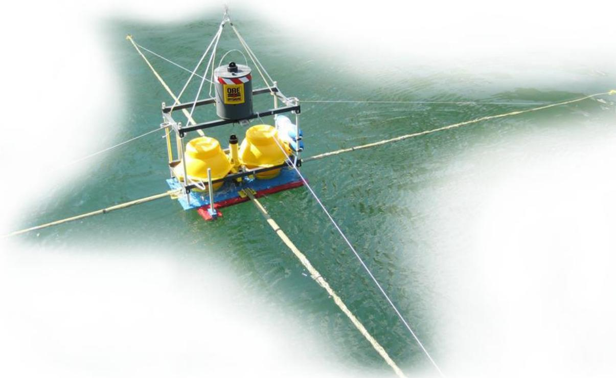
Системы 2AUSS-07A производства канадской фирмы «Advanced Geophysical Operations and Services Inc» предназначены для проведения морских электроразведочных работ на глубинах до 200 метров. Системы базируются на использовании высокоточного и высокочувствительного наземного геофизического оборудования для электроразведочных поисковых работ и построены таким образом, что оборудование с легкостью можно использовать как в сухопутном варианте, так и для синхронной наземной и морской съемки.
