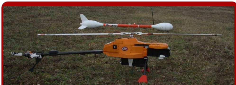
Легкий GEM Hawk (вертолет) хорошо подходит для надежной аэромагнитной съемки с GEM AirBIRD на БПЛА.
