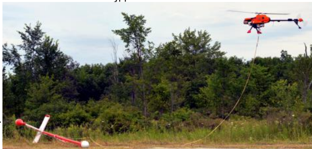
Автономная система с независимым питанием не требует интеграции с навигационными или электрическими системами БПЛА.
