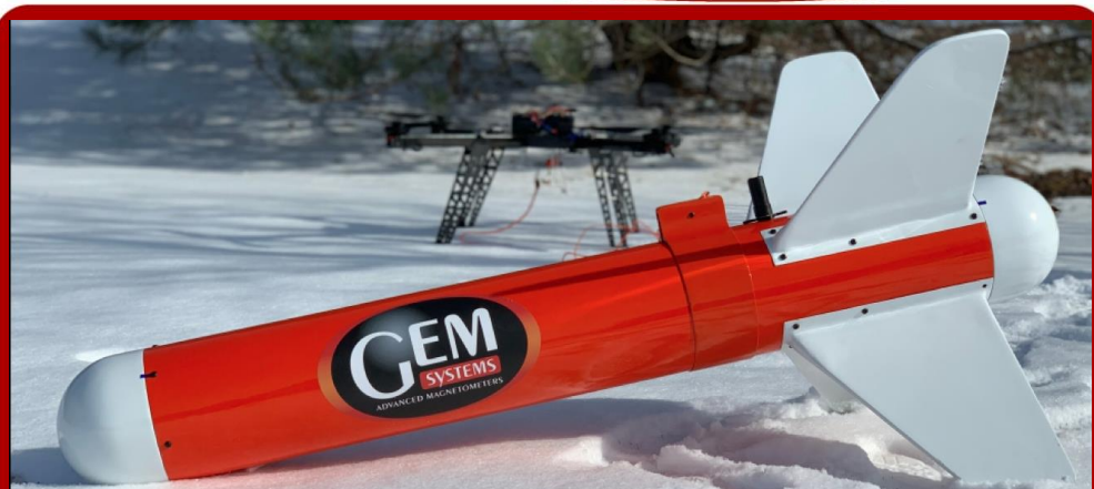
GEM Systems. Система UAV VLF картирует контрасты удельного сопротивления.
