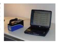
Коммуникационное программное обеспечение ECOPROBE PLUS для Windows9x/NT обеспечивает передачу данных от прибора к компьютеру, и предоставляет основную информацию для интерпретации. Карты изолиний (при использовании, например, программ Grapher, Surfer, или Rockware) готовы примерно через 10 минут!
