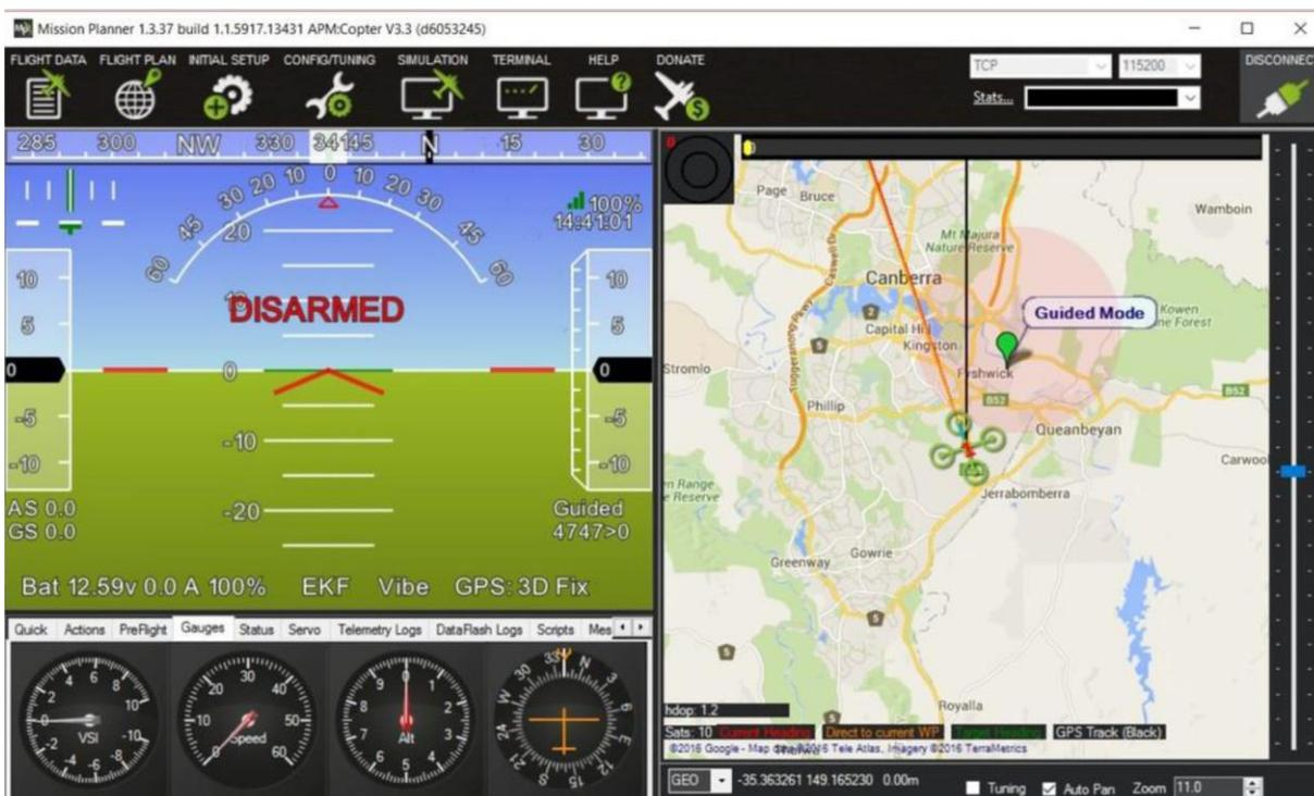
Mission Planner – это наземный пункт управления для аппаратов Plane, Copter и Rover. Эта программа совместима только с Windows. Mission Planner можно использовать в качестве утилиты настройки конфигурации, или в качестве дополнительного средства динамического контроля для вашего автономного летательного аппарата. Ниже перечислены лишь некоторые возможности программы Mission Planner:
