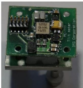
Двух-координатный датчик наклона занимает площадь примерно один квадратный дюйм и весит менее 100 г (3,5 унций). Устройство не имеет подвижных частей, и обеспечивает диапазон измерения 360° по обеим осям (осевое вращение и наклон).
