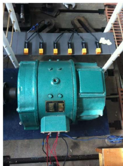
Измерение магнитного поля двигателя постоянного тока
